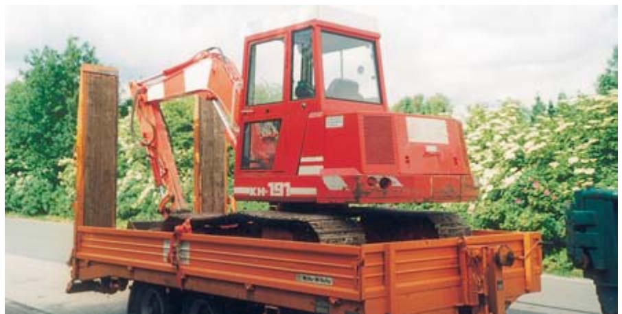
Eine so schwere Maschine kann man auf diesem Anhänger durch Niederzurren nicht sichern – schon gar nicht mit nur einem Zurrgut.
