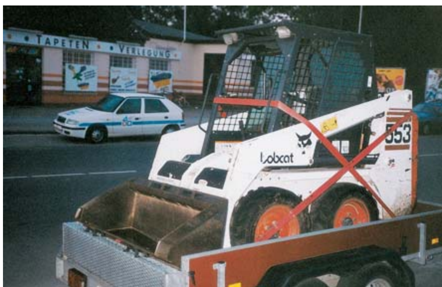
Wenn keine Zurrpunkte an der Maschine vorhanden sind, bietet sich eine Ladungssicherung durch Kopfschlingen an.
