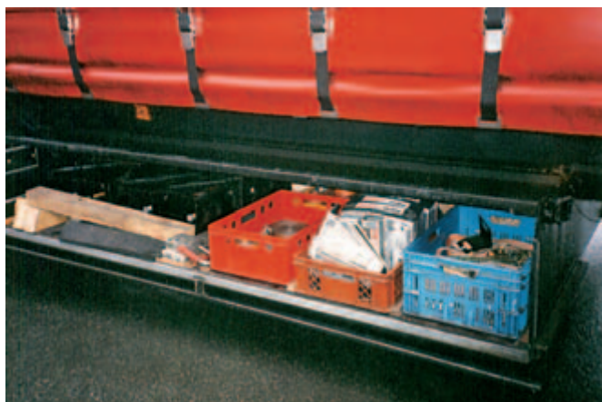
▲ Staukasten an einem Sattelanhänger mit einer soliden Grundausrüstung an Hilfsmitteln zur Ladungssicherung.
