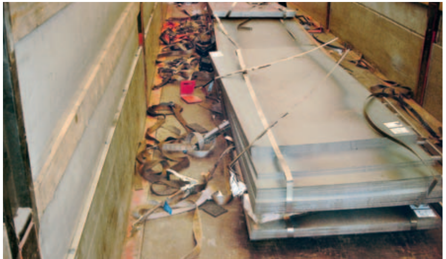
Die Zurrurte, mit denen die Blechpakete niedergezurrt waren, wurden durch die scharfen Kanten zerschnitten.
