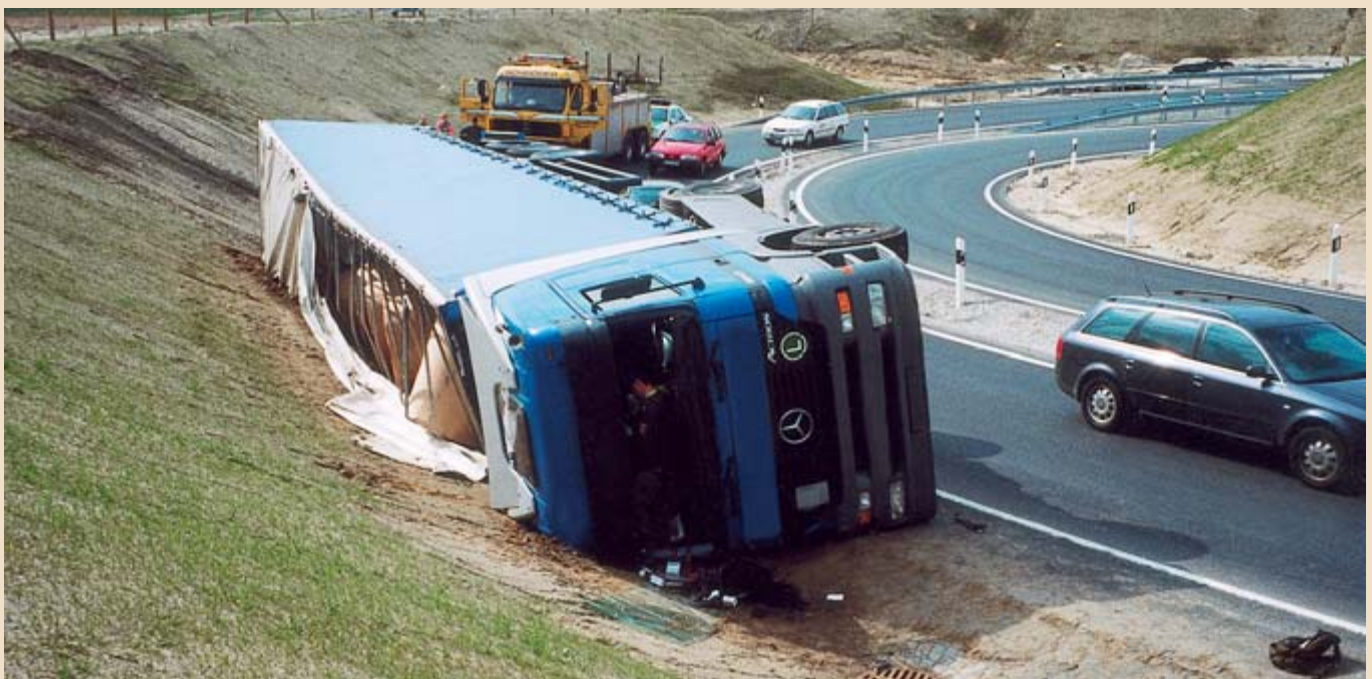
In der Linkskurve rutschte die Ladung nach außen. Dadurch stürzte der Sattelzug auf die rechte Fahrzeugseite.
