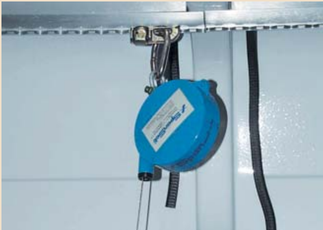
◀ Wenn das Netz nicht benötigt wird, wird es durch eine Drahtseilrolle, die in der Lochschiene am Dach befestigt ist, hochgezogen.
