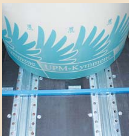
▲ Die Halterung, an der die Antirutschmatten befestigt sind, wird bei der Beladung automatisch nach vorn geschoben.
