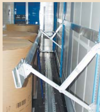
▲ Formschlüssige Sicherung der Rollen durch verstellbare Halterungen.
