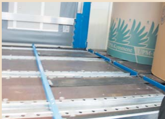
▲ An der blauen Halterung sind vier besonders reißfeste Antirutschmatten befestigt.
