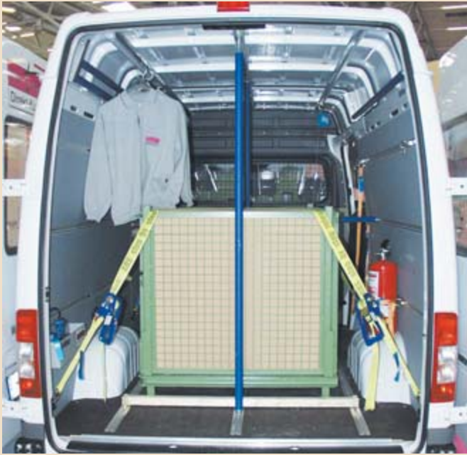
▲ Rückwärtige Ladungssicherung durch einen Holzbalken, einen Sperrbalken und zwei Zurrgurte.
