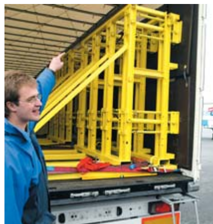
Hydraulische Prüfeinrichtung zur Stabilitätsprüfung.
