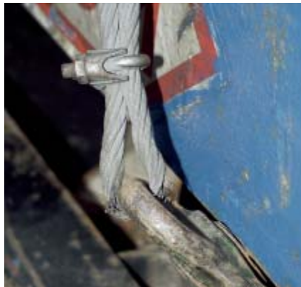
Unzulässige Seilendverbindung mit einer Schraubklemme, zusätzlich fehlt die Kausche.
