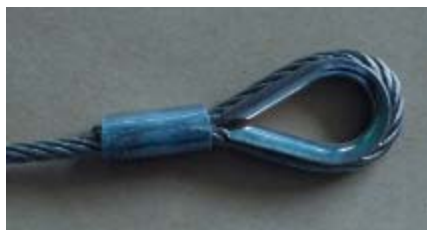
Korrekte Seilendverbindung mit Pressklemme und Kausche.
