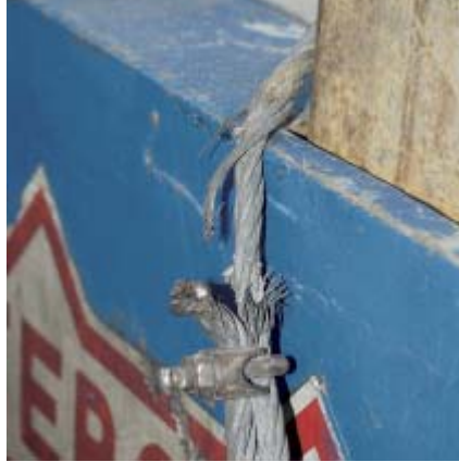
Bei diesem Zurrdrathseil ist eine Litze gebrochen, außerdem fehlt hier ein Kantenschutz.
