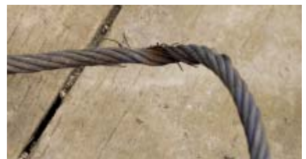
Dieses Zurrdrahtseil ist zu stark gequetscht.
