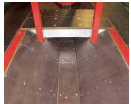
Zur Sicherung schwerer Coils sind Einsteckungen zwingend erforderlich.
