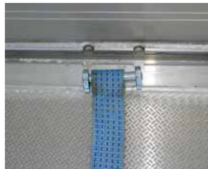
In dieser Zurrschiene können Zurrgurte mit einem speziellen Verbindungselement befestigt werden.
