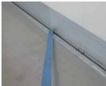
Dieser Kühlkoffer ist auf beiden Seiten der Ladefläche mit einer Zurrschiene ausgerüstet.
