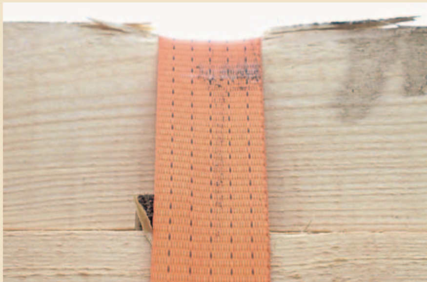
▲ Der Holzbalken wurde durch den Zurrgurt eingeschnitten. Ladungsschäden und Schäden am Zurrmittel sind vorprogrammiert, wenn man keinen Kantenschutz benutzt.
