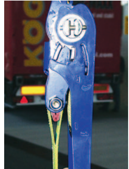
▲ Diese Ratsche verfügt über ein integriertes Vorspannkraftmessgerät (TFI). Der TFI (rot) befindet sich dort, wo der Gurt an der Ratsche befestigt ist.
