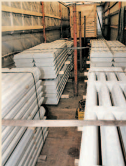
▲ Durch diese Ladelücken wird das Niederzurren wirkungslos. Die Ladung ist praktisch ungesichert.
