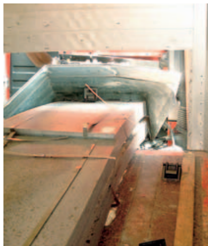
Die rutschenden Blechpakete durchschlugen bei einer Vollbremsung aus ca. 30 km/h die Stirnwand.
