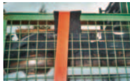
Antirutschmatten sind beim Niederzurren als Kantenschutz unsinnig.
