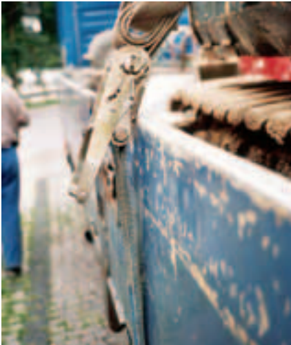
Die Ratsche kann an der Kante beschädigt werden.
