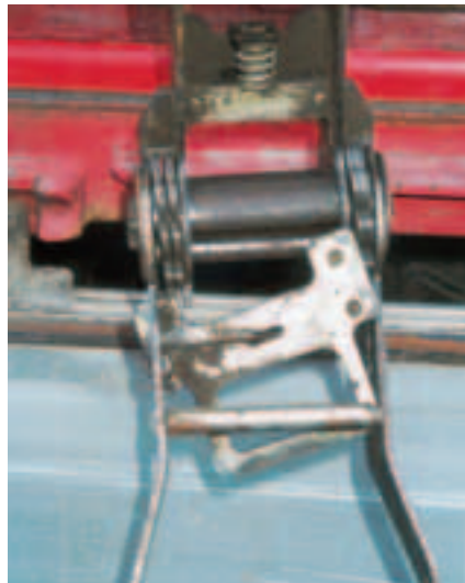
Diese Ratsche kann nicht sicher verriegelt werden und ist deshalb unbrauchbar.
