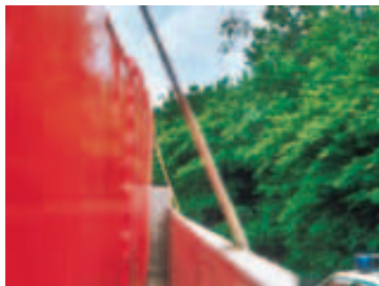
Dieses Niederzurren ist unwirksam, denn die Vorspannkraft wird durch die Bordwand „abgefedert“.
