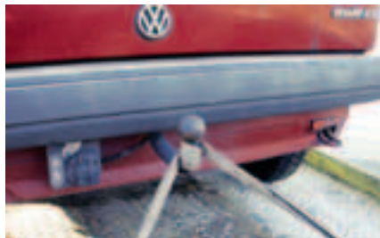
Weil der Gurt „mitrutscht“ kann sich die Ladung innerhalb dieser Umschlingung bewegen.
