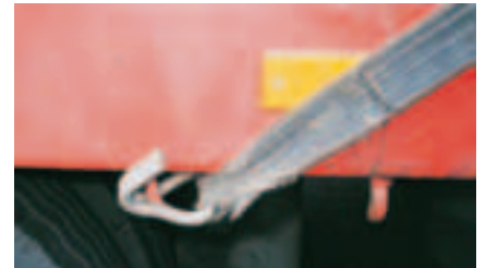
Ein Planenhaken darf nicht als Zurrpunkt genutzt werden.
