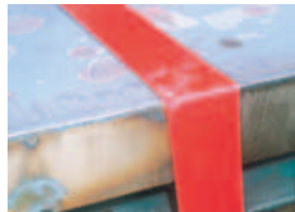
An dieser scharfen Kante wird sich der Zurrgurt sehr schnell durchschneiden.
