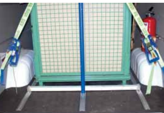
Durch die baulichen Voraussetzungen dieses Fahrzeugs lässt sich die Gitterbox sehr schnell und effektiv sichern.
