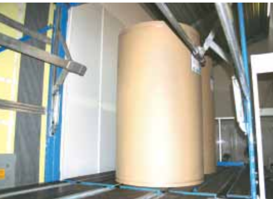
Die Rollen werden außerhalb des Fahrzeugs auf einer Verladebühne bereitgestellt.
