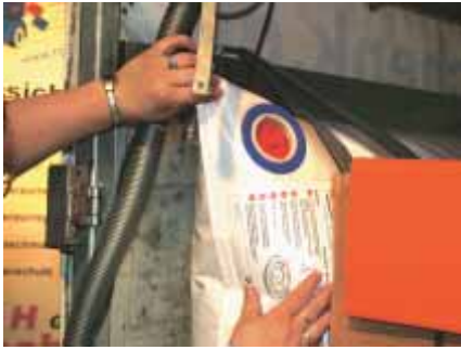
Vor dem Entladen muss nur das rote Sicherheitsventil geöffnet werden.
