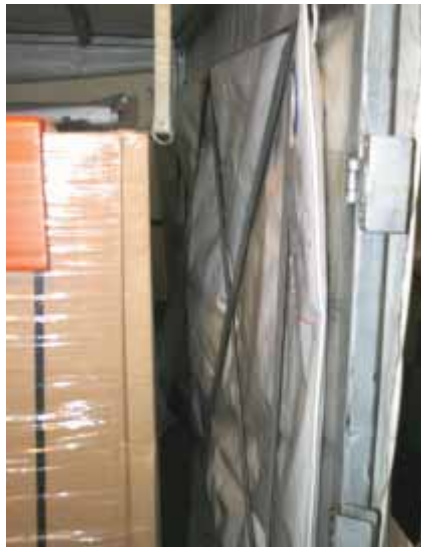
Der an stabilen Gummibändern aufgehängte Luftsack nimmt kaum Platz im Laderaum ein.
