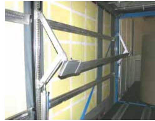
Die Halterungen werden per Luftdruck gesteuert.
