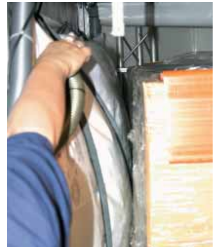
Der Schlauch wird auf das rote Sicherheitsventil aufgesteckt und der Luftsack wird innerhalb weniger Sekunden aufgeblasen.
