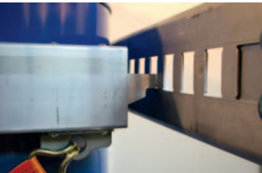
Der Sperrbalken lässt sich in Schritten von 30 mm einhaken.
