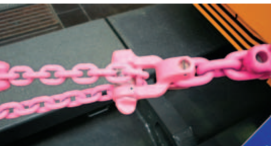
Die Umlenkrolle gleicht Spannungsunterschiede aus.
