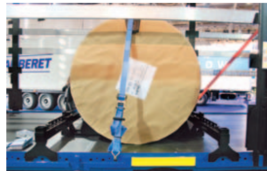
Das Multipaper Sicherungssystem für liegende Papierrollen
