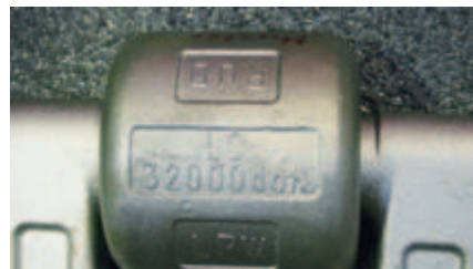
Neue Kennzeichnung eines in der Ladungssicherung mit 32000 daN belastbaren Zurrpunktes
