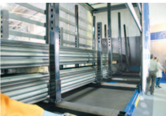
Das Multi Fix Stecksystem für schweres Langgut
