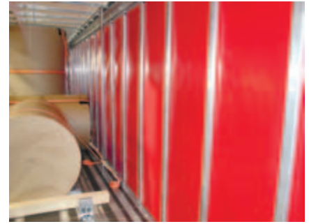
Die „Quick Slider“ Plane mit integrierten Rungen
