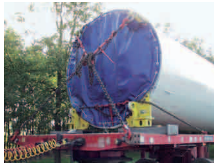
Spannelemente mit separater Kette als Kopfschlinge und als Diagonalzurrung
