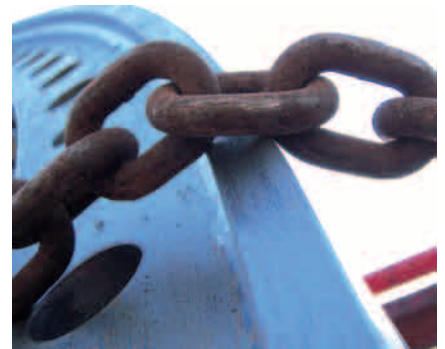
Die Kette stützt sich ab und das mittlere Kettenglied kann nicht knicken.
