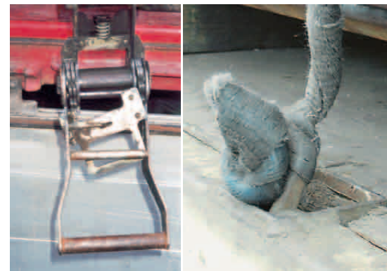
Dieser Sperrschieber kann die Wickelwelle nicht arretieren, somit kann sich der Gurt jederzeit lösen.
