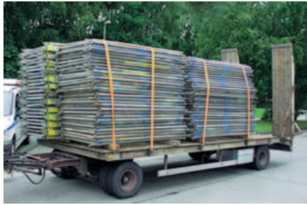
Diese gestapelte Ladung ist so instabil, dass sie nur durch Niederzurren nicht ausreichend gesichert werden kann.
