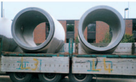
Jedes dieser ungesichert transportierten Rohre hatte ein Gewicht von etwa 5 Tonnen.
