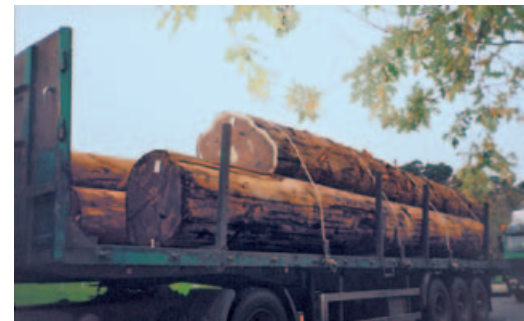
Diese Ladung Baumstämme kann durch Niederzurren mit vier Zurrgurten nicht ausreichend gesichert werden.
