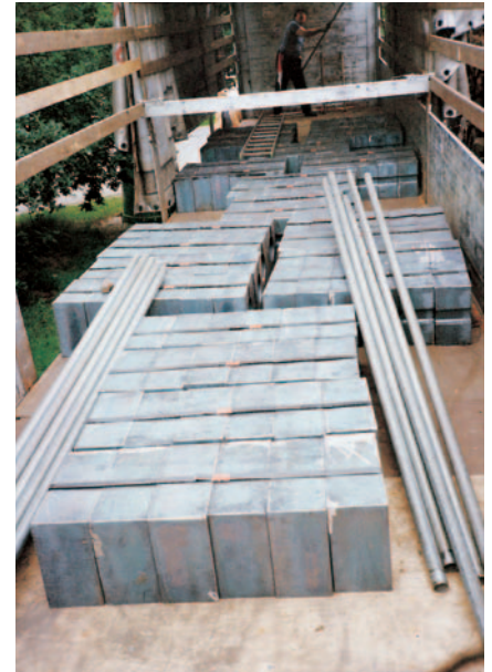
Dieser ungesicherte Stahl...
