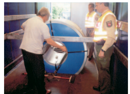
Etwa 20 Tonnen Stahl – ungesichert.
