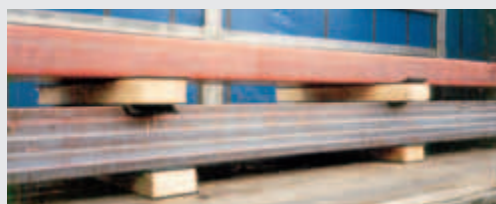
Antirutschbalken dienen als Auflage.
