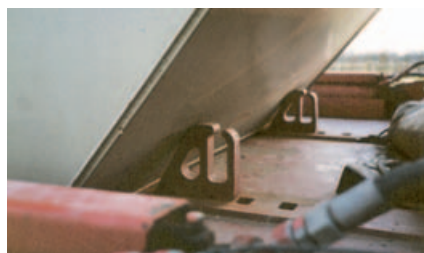
Formschlüssige Sicherung eines Absetzbehälters in Fahrtrichtung
