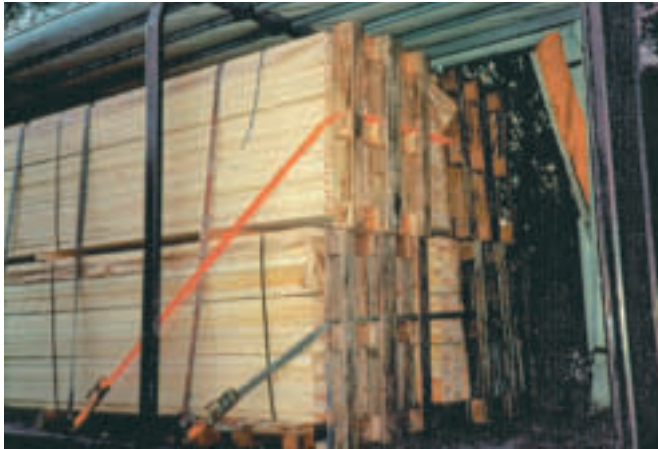
Formschluss nach vorn durch Kopfschlingen
