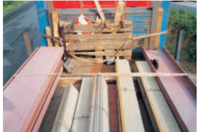
Auch in diesem Fall sorgen die Ladelücken für ein hohes Risiko. Das Niederzurren ist somit unwirksam.
