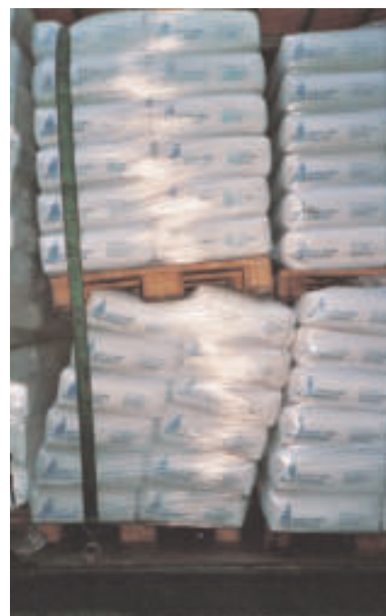
Negative Beispiele: So wird die Ladung beschädigt und nicht gesichert.
