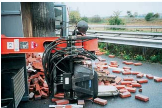
Beim Umkippen wurde der Lkw mit dem Ladekran stark beschädigt.
