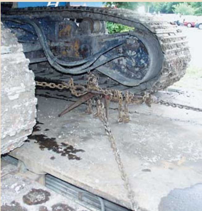
Wenn die Zurrketten etwa in diesem Winkel gespannt werden, können sie die Ladung optimal sichern.
