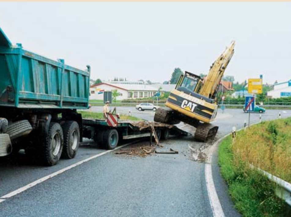
In der Kurve rutschte der ungesicherte Bagger von der Ladefläche.
