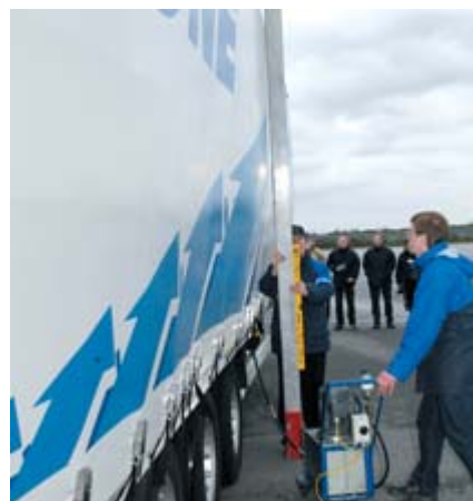
Die Plane darf sich maximal 30 Zentimeter nach außen wölben.
