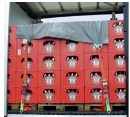
Das Bild zeigt eine Möglichkeit der zusätzlichen Ladungssicherung von Getränken. Die Plane wird quer zur Fahrtrichtung über die Kisten gespannt. Beim Niederzurren verteilt sie die Kraft gleichmäßig auf die Ladung, ohne sie dabei zu beschädigen. Diese Planen gibt es auch in kompletter Fahrzeuglänge.
