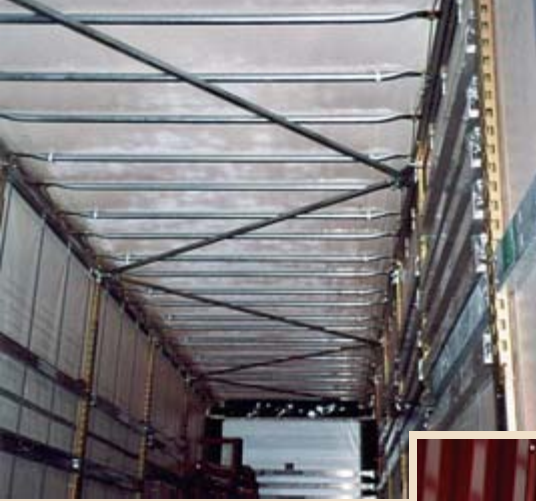
▲ Das Dach muss in der Lage sein, große Kräfte aufzunehmen. Deshalb muss ein aufschiebbares Verdeck verstärkt werden. Diese Verstärkung kann z. B. aus Metallstreben oder aus verspannten Drahtseilen bestehen.
