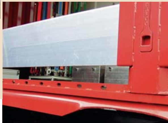
◀ Das Foto zeigt eine Palettenanschlagleiste und zwei übereinander liegende Aluminium-einsteckprofile. Diese Einrichtungen sind ausreichend stabil und können die hohen Kräfte aufnehmen.
