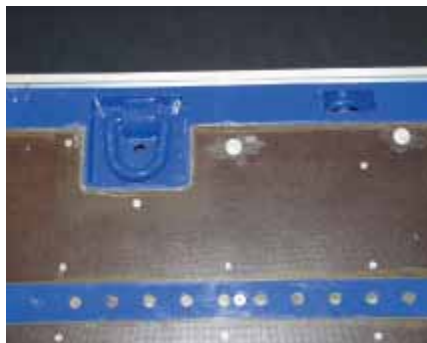
Unterschiedlich belastbare Zurpunkte auf der Ladefläche eines Sattelanhängers.
