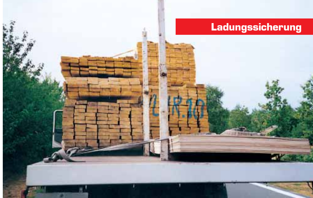
Durch den Einsatz von Mittelrungen kann eine kippgefährdete Ladung stabilisiert werden.
