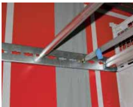
Einsteckprofil eines Curtainsiders mit Lochraster zur Aufnahme von Sperrstangen
