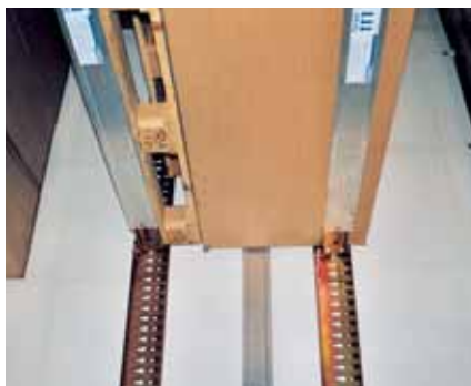
Ankerschienen mit Ladebalken ermöglichen eine Doppelstockbeladung.
