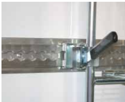
Airline Schiene mit einer Klemme zum Befestigen von Rollwagen
