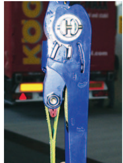
▲ Diese Ratsche verfügt über ein integriertes Vorspannkraftmessgerät (TFI). Der TFI (rot) befindet sich dort, wo der Gurt an der Ratsche befestigt ist.
