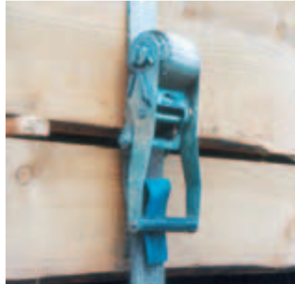
Bei dieser Ratsche befindet sich zuviel Gurt auf der Schlitzwelle.
