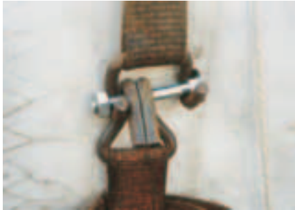
Diese Schraube darf nicht als Verbindungselement eingesetzt werden.
