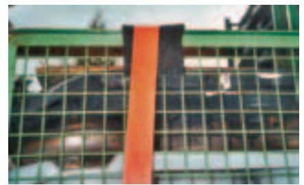
Antirutschmatten sind beim Niederzurren als Kantenschutz unsinnig.
