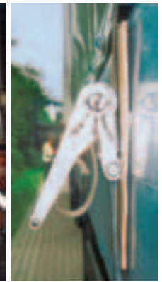
Der Griff der Ratsche muss geschlossen und dadurch verriegelt werden.
