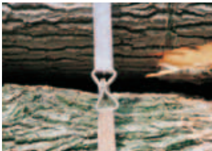
Wenn die Zurrhaken so ineinander gehakt werden können sie brechen.
