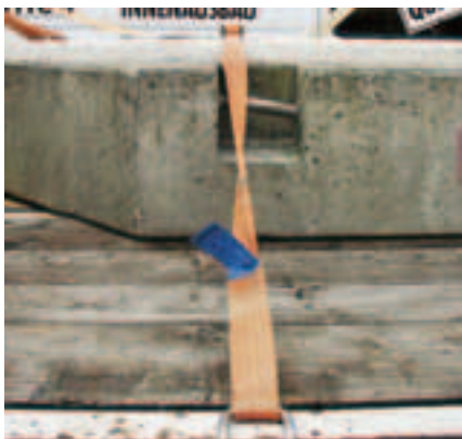
Durch solche Verdrehungen können die Gurtkanten überlastet werden.
