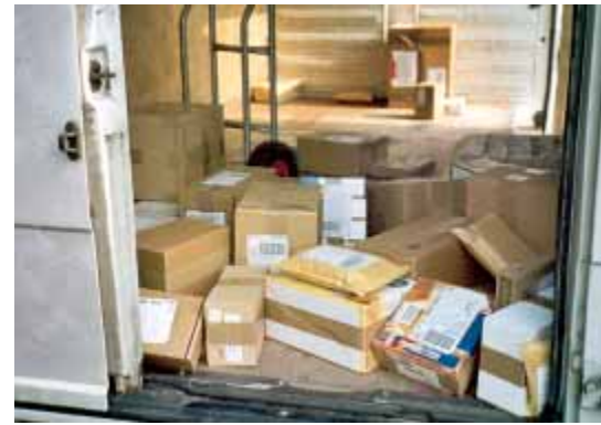
Wenn Stückgut so wie hier „in loser Schüttung“ transportiert wird, sind Ladungsschäden sehr wahrscheinlich.
