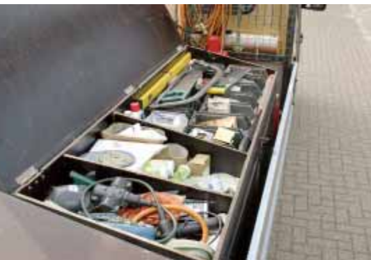
Dieser Kasten ist fest mit der Ladefläche verschraubt. Er bietet die Möglichkeit, Kleinteile und Werkzeuge sicher zu transportieren.
