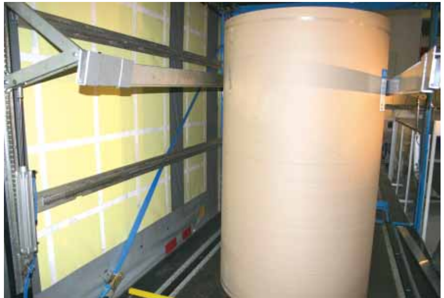
Die Rollen werden zwischen den Halterungen eingeklemmt.
