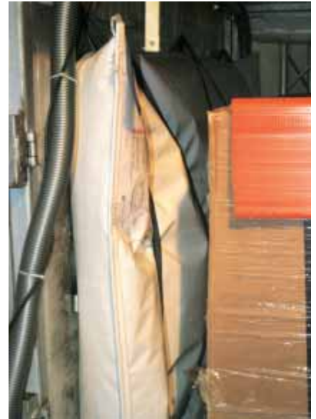
Noch während die letzte Luft entweicht, kann die jetzt wieder frei stehende Ladung abgeladen werden.
