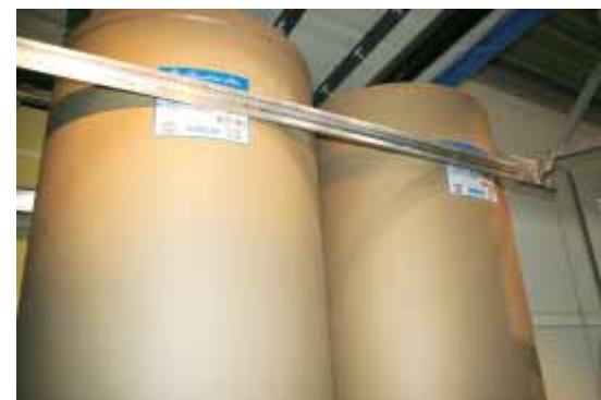
Durch diese formschlüssige Ladungssicherung sind die Rollen ausreichend gegen Rutschen und gegen Kippen gesichert.
