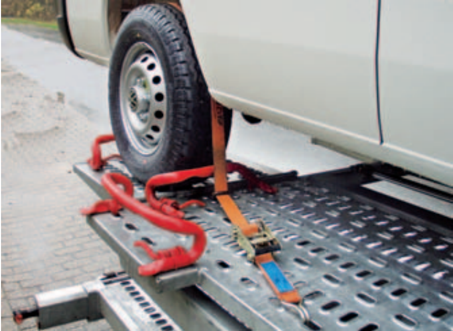
Diese Sicherung mit Radvorleger und Drei-Punkt-Zurrgurt ist korrekt.
