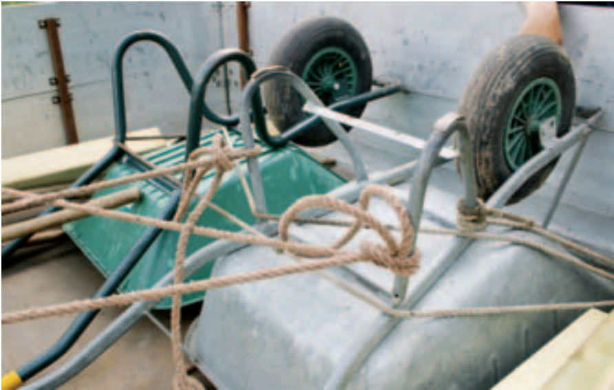
Dieses Hanfseil darf zur Ladungssicherung nicht eingesetzt werden, denn es entspricht keiner DIN EN Norm.
