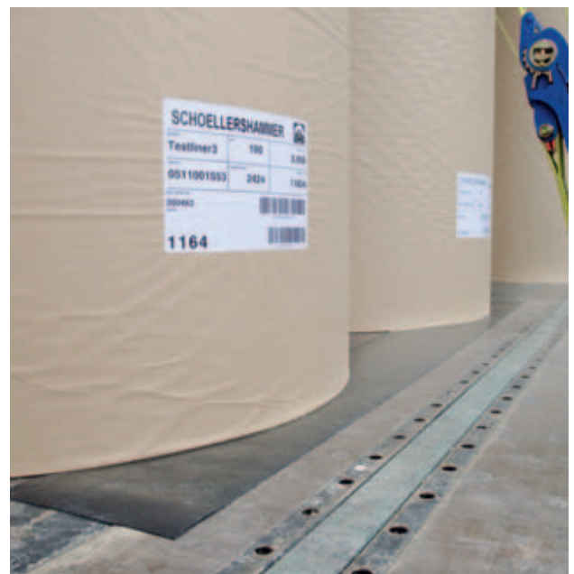
Detaildarstellung der unterlegten SpanSet Grip Rollenware zur Ladungssicherung von Papierrollen auf Lkw
