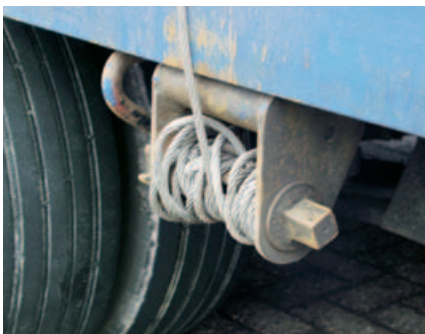
Dieses Seil kann keine Vorspannkraft halten.
