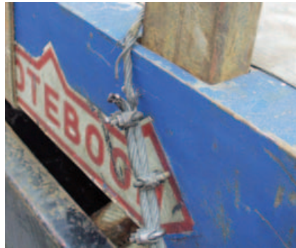
Ablegereife wegen Drahtbruch und wegen der Verwendung von Schraubklemmen
