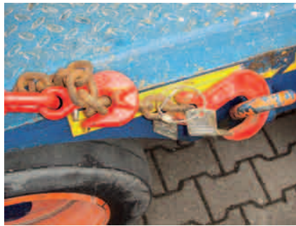
Diese Kette hat einen zweiten Anhänger mit dem Prüfdatum.
