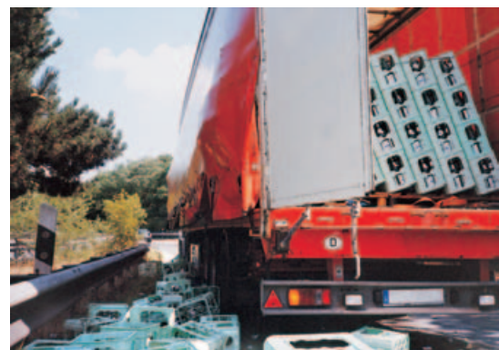
In der Kurve kippte die Ladung in die Plane. Die Krafteinwirkung war zu groß und überlastete den Fahrzeugaufbau.
