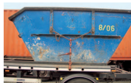
Eine Y-Zurrung ist Niederzurren. Diese Sicherungsart ist für schwere Absetzbehälter nicht ausreichend.
