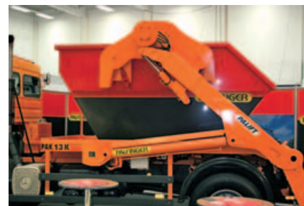
Das Fahrzeug verfügt über Teleskopausleger mit fest verbundenen Behälteraufnahmen.
