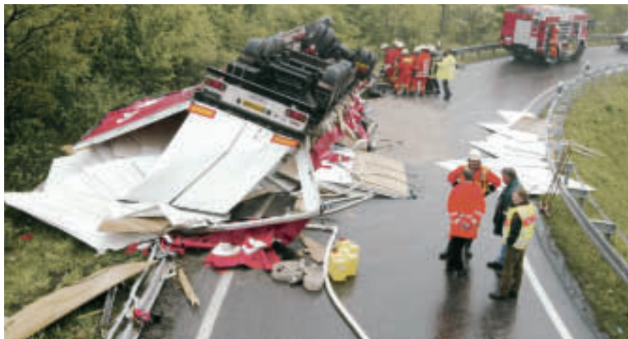
Die rutschenden Spanplatten entwickelten eine so große Kraft, dass dadurch der gesamte Sattelzug auf dem Dach landete. Foto: Lewandowski
