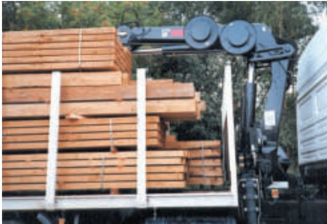
Wegen dieser Ladelücken kann die Ladung bei einer Vollbremsung nach vorn rutschen und die Stirnwand beschädigen.
