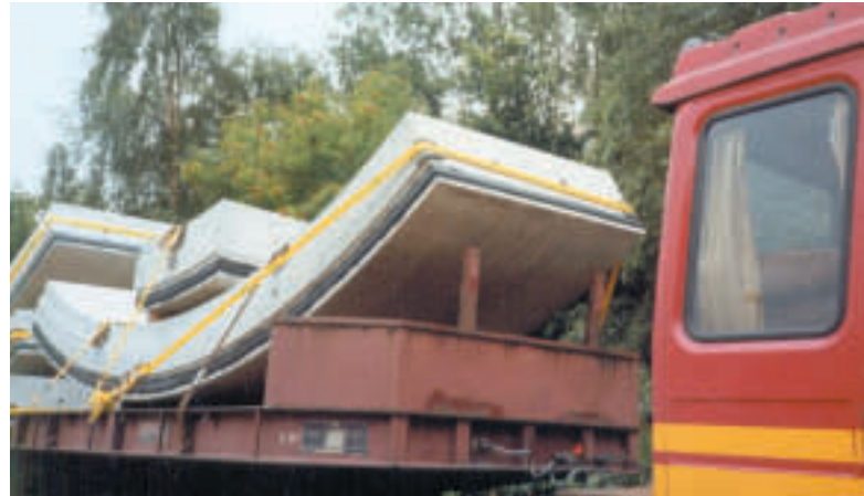
Mit einer kombinierten Ladungssicherung – wie auf diesem Foto – hätte der Unfall vermieden werden können.
