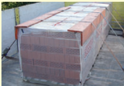
Ladungssicherung durch Niederzurren
