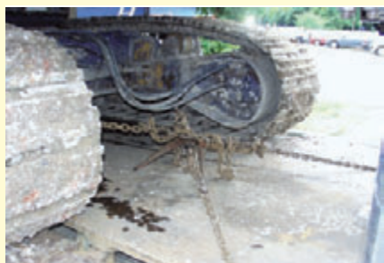
Ladungssicherung durch Diagonalzurren
