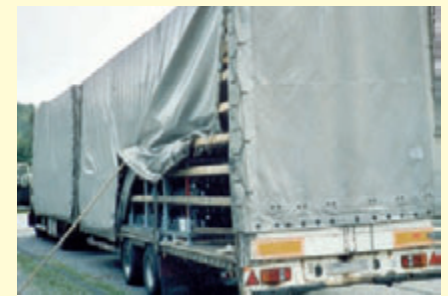
Pritschenaufbau mit Plane und Spriegel
