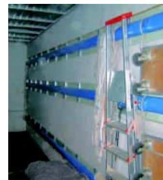
Hier sind die Zurrschienen mit Polstern ausgestattet.
